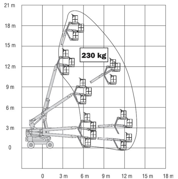
"falsche Gelenk-Teleskopbühne", da Unterarm nicht separat steuerbar ist ==> Elektro-Teleskopbühne
